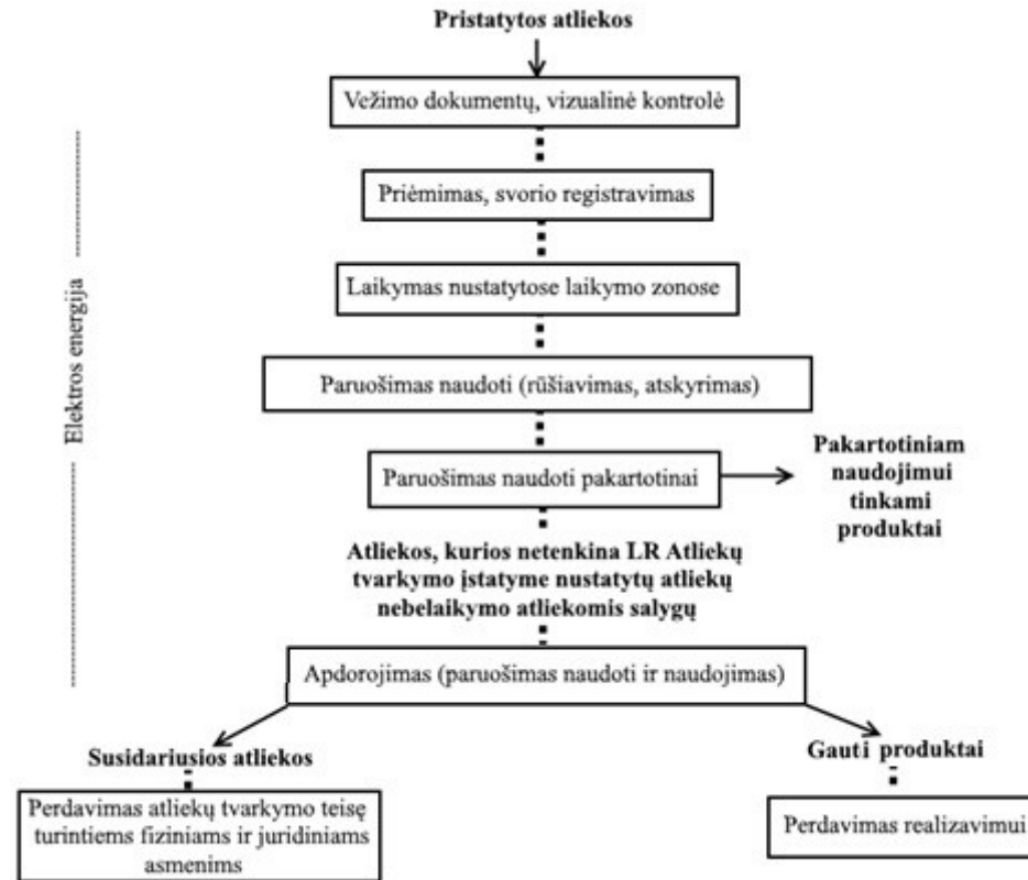
6 pav. Tepalų filtrų atliekų naudojimo technologinio proceso schema
